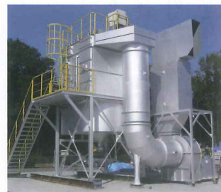
トンネル工事用の集塵機(写真左下)や高炉などに常設される集塵機(中下)。 独自のフィルタ構造(右下)で高い集塵力を実現した大型の集塵機は、幅広い分野で活用されている
